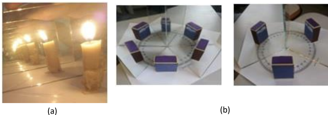
Figura 3.7 – Imagens fotográficas (a) espelho em paralelo e (b) variando o ângulo.
