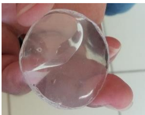
Figura 2.8 – Foto da lente esférica biconvexa confeccionada pelo autor com garrafa pet .
