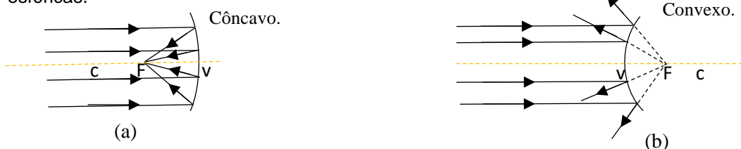
Figura 1.15- Desenho esquemático simulando os raios paralelos de luz incidindo sobre superfícies esféricas.
