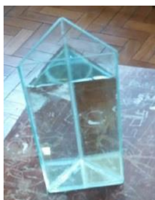
Figura 1.2 – Imagem fotográfica do prisma pronto. Parte externa feita com placas de vidro e dentro água
