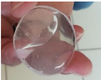
Figura 2.6 – Foto da lente esférica biconvexa confeccionada pelo autor com garrafa pet.
