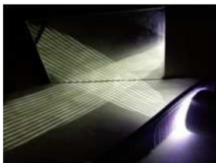
Figura 1.8 – Imagem fotográfica do efeito da luz passando pelo pente e refletindo no espelho.
